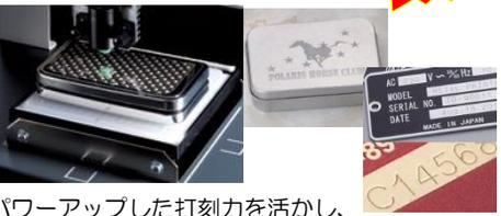
パワーアップした打刻力を活かし、工業製品の製造工程における「銘板」「部品」や「板金」などへ、シリアルナンバーや生産情報を鮮明にマーキングできます。
